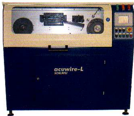
Die Honmaschine Acuwire-L maximiert die Qualität von Bohrungen an kleinen Teilen.
