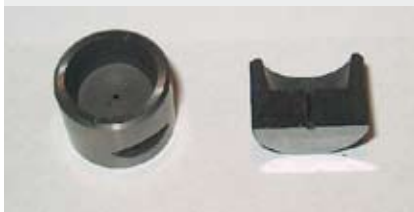
Bild 7: Matrizen aus Hartmetall ID 0,960 +/- 0,001
