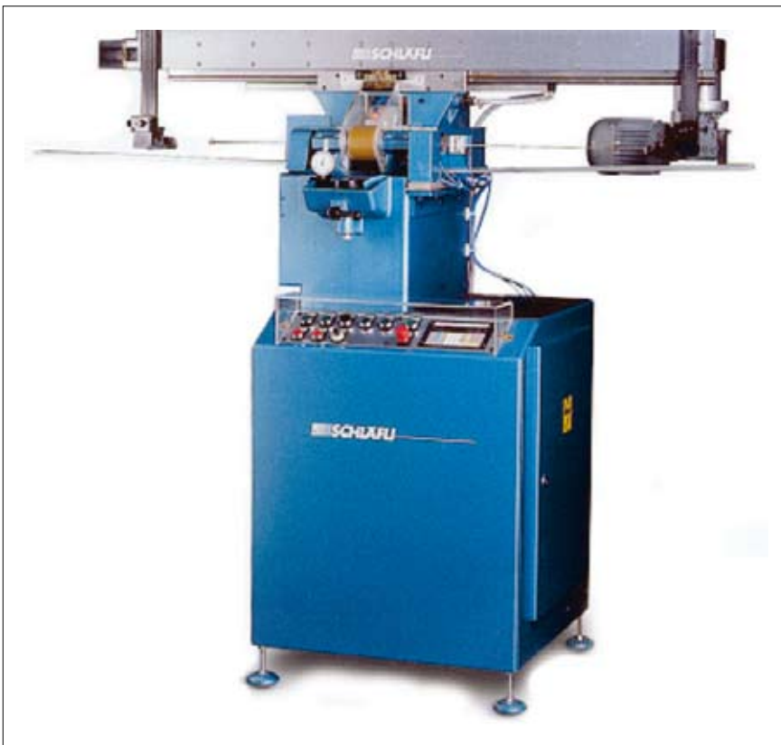
Bild 8: Die PreciGrind 2000 ist eine Centerless-Schleifmaschine, deren Maschinenkonzept auf das Herstellen von hochgenauen Konzentritättoleranzen (Innen- zu Aussendurchmesser) ausgelegt ist (Werkbilder: Schlächli Engineering AG, CH-Büren a. A.)
